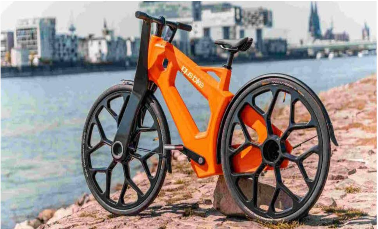
Tanpa korosi dan perawatan minim, dan tidak menggunakan pelumas, sepeda plastik atau igus®:bike. Plastik yang digunakan adalah hasil daur ulang. Sepeda plastik ini merupakan yang pertama di dunia dan tepat digunakan di kota-kota yang sarat polusi. Sepeda plastik terbaru tanpa logam (Sumber: igus® GmbH)
